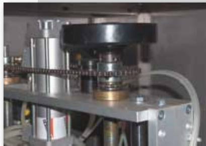
Mechan. nastavení pozice ghilotinových čelistí
