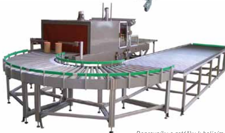
Dopravníky a zatáčky k balicím strojům
